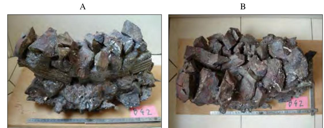
L'évolution des températures est observée, en divers endroits du dispositif, par de simples résistances en inox protégées par des briques creuses. En moins de deux heures, on obtient une épaisseur de 20 cm de roches soudées, soit 22 kg pour moins de 20 kg de charbon de bois consommé. Une partie notable de cette consommation est perdue dans les parois en brique qui délimitent notre montage. Ces pertes n'existent pas en vraie grandeur.
